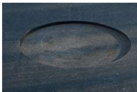
Фрезерованный центр для подпятника домкрата аутригера
